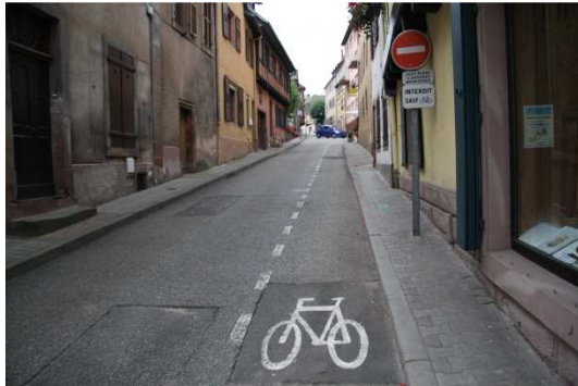
Exemple de signalisation d'un double sens cyclable à Saverne
